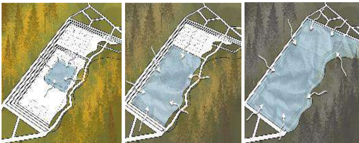
Il. 7 – Schemat okresowego zatapiania boiska
