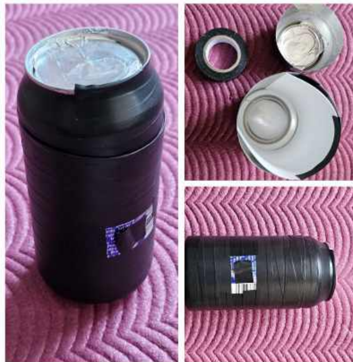
Fotos 3. Przygotowanie aparatu z puszki do solarigrafii – archiwum własne autora
