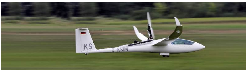
Rys. 1. Szybowiec Ventus 2cxM z wysuniętym silnikiem startowym
